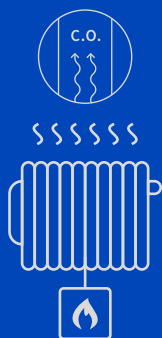
ZASILANIE WODNE Z INSTALACJI CENTRALNEGO OGRZEWANIA
